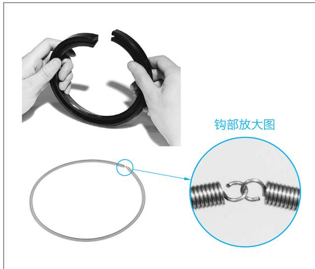
〈图7-20.〉 MG型油封的切断方法
