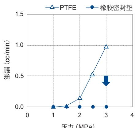
试片尺寸: Φ60 mm 密封介质: 空气 温度: 室温
